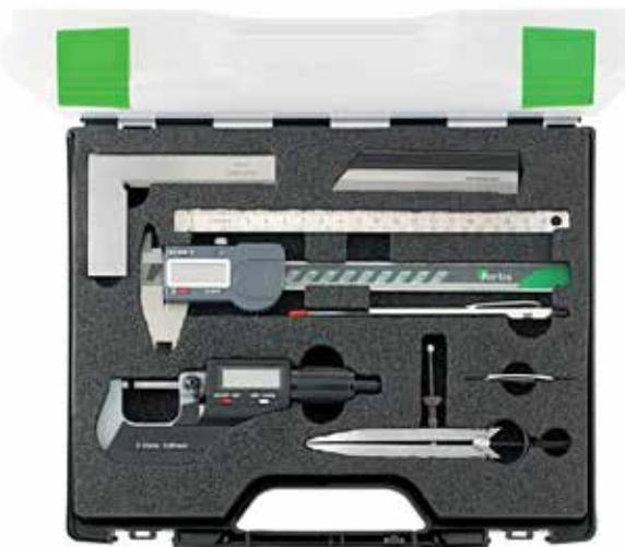
**Lieferumfang:** Taschenmessschieber Digital 150 mm, Bügelmessschraube Digital 0 – 25 mm, Haarwinkel 100 x 70 mm DIN 875/00, Haarlineal 100 mm DIN 874/00, Federzirkel 100 mm, Maßstab 200 x 13 x 0,5 mm, Reißnadel 180 mm, in Kunststoffkasten
