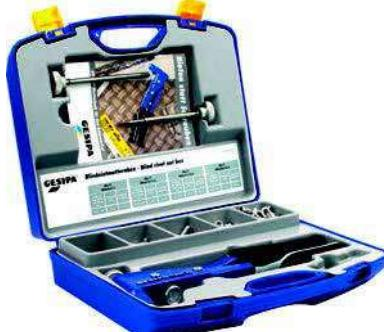
**Lieferumfang:** GBM 10 mit Gewindedorn und Mundstück M 5, zusätzliche Gewindedorne und Mundstücke M4 und M6, verschiedene Blindnietmutter-Abmessungen M 4 – M 6 aus Alu für nietbare Materialstärken 0,25 – 3 mm
