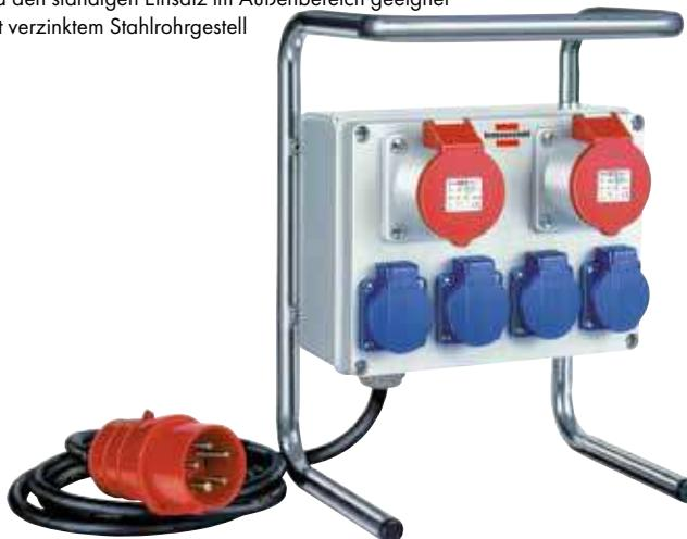
**Lieferumfang:** 4x Schutzkontakt-Steckdosen 230 V/16 A auf allen 3 Phasen verteilt mit spritzwassergeschützten und selbstschließenden Deckeln und 2 CEE-Steckdosen 400 V/16 A sowie 1 Stecker CEE 400 V/16 A, 5-polig.
