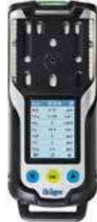
**Lieferumfang:** Dräger X-am 8000 Gerät mit folgender Sensorbestückung: Dual IR Ex/CO<sub>2</sub>, XXS-Sensor O<sub>2</sub>, XXS-Sensor CO LC/H<sub>2</sub>S LC, inkl. integrierter Pumpe, Bluetooth zur Nutzung und Unterstützung CSE Connect, Ladegerät und Steckerzeugteil, Hersteller- und Kalibrier-Zertifikat, messtechnisches Gutachten
