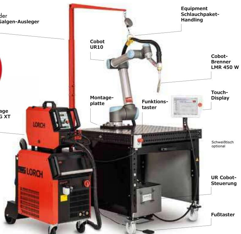
**Lieferumfang:** Komplett schweißfertiges Set bestehend aus: Cobot UR10 Universal Roboter komplett mit Steuerung, Display und Lorch Systemsoftware, Lorch S5 RoboMIG SpeedPulse XT, Balancer, Brenner, **ohne** Schweißtisch
