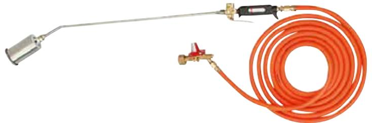
**Lieferumfang:** Propan-Brennergriff mit langem Momentehebel, Brenneinsatz mit Luftanpassung Ø 60 mm, Klein-Regler 0,5 – 4 bar mit Kombianschluss für 5 – 33 kg Flaschen, 1 Schlauchbruchsicherung, 1 HD-Schlauch 5 m, G3/8" LH
