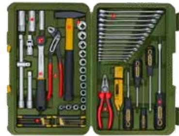
**Lieferumfang:** 14-teiliger Ring-Gabelschlüsselsatz 6 – 19 mm, 14x Steckschlüsseleinsätze 1/2" 8 – 24 mm, Umschalratsche, Kardangeln, Verlängerung 125, 250 mm, Zündkerzen 16 – 18, 21 mm, FLEX-DOT-Schraubendrehersatz: Schlüsselsatz, 8-teilig, für Innensechskantschrauben (HX) 1,5 – 8,0 mm, Dito für TX-Schrauben von TX 9 – 40, Autolichtprüfer, Knipex-Kombizange 180 mm, Knipex-Wasserpumpenzange 240 mm, Schlosserhammer (300 g).
