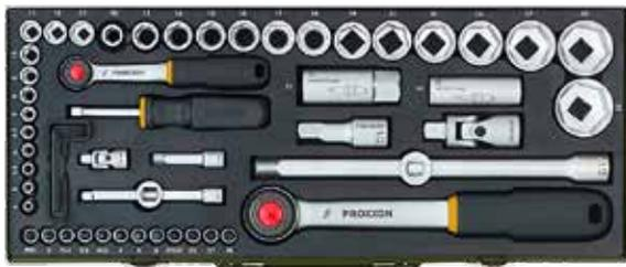
**Lieferumfang:** Steckschlüsseleinsätze von 4 – 32 mm, Zündkerzenspezialeinsätze 16, 21 mm, Schraubereinsätze mit Vierkantantrieb für Schlitzschrauben, Kreuzschlitzschrauben, TX-Schrauben (mit stirnseitiger Bohrung) und Innensechskantschrauben, Innensechskantschlüssel (abgewinkelt) 1,25; 1,5; 2,0; 2,5; 3,0 mm, mit Entriegelungsmechanismus
