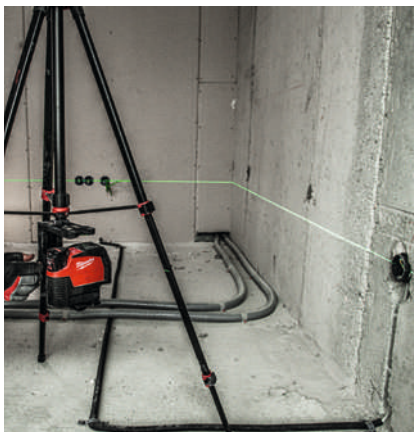
TRP 180: Bodennahe Verwendung mit 360°-Laserhalterung (optional erhältlich)
