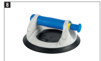
8 Griff mit rutschfester Ummantelung, Tragrichtung parallel, Vakuumsicherheitsanzeige, Tragkraft 120 kg, Lieferung im Koffer.
