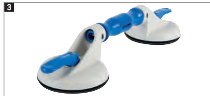
3 Kunststoff-Körper, großflächiger, rutschfester Griffbereich, ergonomischer und bedienfreundlicher Kipphebel, Tragkraft ca. 50 kg.
