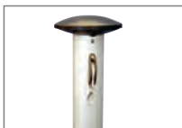
HI Mastkopf schwarz, halboval, Kausche, Kunststoffkarabiner, innen liegendes Hiss-Seil und Kletterstoppgewicht.
