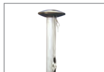
HA Mastkopf schwarz, halboval mit Kausche und Kunststoffkarabiner, außen liegendes Hiss-Seil und Klampe.
