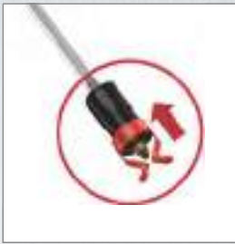
Schraubkralle auf die Klinge schieben, bis die Spitze heraustritt.
