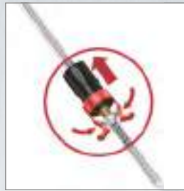
Schraubkralle weiterschieben, bis die Arme leicht gespreizt am Schraubenkopf anliegen.
