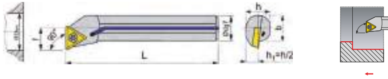
Abb.: Rechtsausführung Lieferung ohne Wendeschneidplatten.
