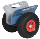
1 Plattenroller: mit Klemmbacken. Sichere Klemmung durch das Gewicht des Ladegutes auf die Klappkonstruktion, max. Klemmbreite 0–60 mm.
