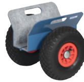
2 Plattenroller: mit Klemmbacken. Sichere Klemmung durch das Gewicht des Ladegutes auf die Klappkonstruktion, Klemmbreite 30–95 mm.
