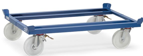
Robuste Winkelstahl-Schweißkonstruktion, mit 4 Fangecken. Pulverbeschichtet blau RAL 5007. 4 Lenkrollen mit Polyamid-Rädern, Nabens mit Präzisionskugellager. 2 Lenkrollen mit Totalfeststeller im Vorlauf, diagonal angeordnet. Unterfahrhöhe: 235 mm
