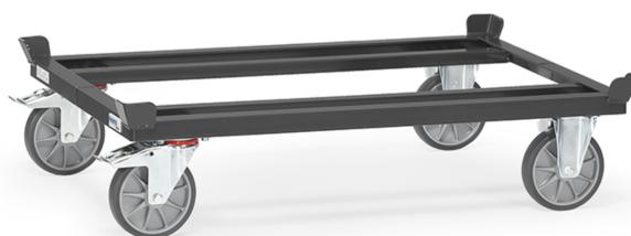
Für Flachpaletten und Gitterboxen. Robuste Winkelstahl-Schweißkonstruktion, mit 4 Fangecken, pulverbeschichtet, anthrazitgrau RAL 7016. 2 Lenk- und 2 Bockrollen, TPE-Bereifung, Nabens mit Rillenkugellager, Feststeller an den Lenkrollen, gemäß der europäischen Norm EN 1757-3 (Sicherheit von Plattformwagen). Standard-Beräderung für mittlere Belastungen. Geräuscharmer Lauf.
