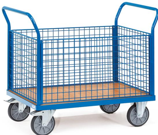
Vierwandwagen aus Stahlrohr und Profilstahl geschweißt, pulverbeschichtet blau RAL 5007. Plattform Holzwerkstoffplatte, Oberfläche Buchendekor. 2 Stirnwände und 2 Längswände aus Drahtgitter 50 x 50 x 4 mm, Wände 500 mm hoch. Eine Längswand zum leichteren beladen und entladen herausnehmbar. 2 Lenk- und 2 Bockrollen mit TPE-Bereifung, Nabensicherung. Feststeller an den Lenkketten, gemäß der Europäischen Norm EN 1757-3 (Sicherheit von Plattformwagen).
