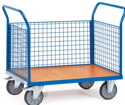
Stahlrohr und Profilstahl geschweißt, pulverbeschichtet RAL 5007, Plattform Holzwerkstoffplatte, Oberfläche Buchendekor. 2 Stirnwände und 1 Längswand aus Drahtgitter 50 x 50 x 4 mm, Wände 500 mm hoch. 2 Lenk- und 2 Bockrollen, TPE-Bereifung, Nabenhügel mit Rillenkugellager. Feststeller an den Lenkkörpern, gemäß der Europäischen Norm EN 1757-3 (Sicherheit von Plattformwagen).
