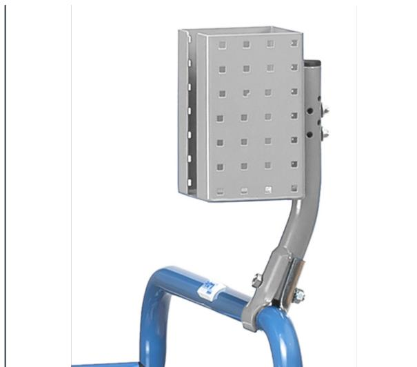
Scannerhalter aus Stahlblech, pulverbeschichtet lichtgrau RAL 7035. Rohrstrebe vielfach gelocht, mit einer Klemmschelle zur Befestigung der Scannertasche an fast allen fetra-Produkten in fast allen Positionen. Scanneraufnahme B x T x H: 120 x 87 x 150 mm, Vordere Öffnung: 40 mm breit
