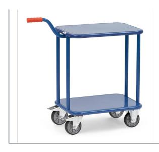
Aus Stahlrohr geschweißt mit Stahlblechplattform. 2 Plattformen mit bündig eingeschweißtem Stahlblech 2 mm stark, pulverbeschichtet brillantblau RAL 5007. Griff anschraubbar. 2 Lenk- und 2 Bockrollen, TPE-Bereifung (spurlos), Naben mit Rillenkugellager, Feststeller an den Lenkrollen, gemäß der Europäischen Norm EN 1757-3 (Sicherheit von Plattformwagen). Tragkraft obere Ladefläche 100 kg.
