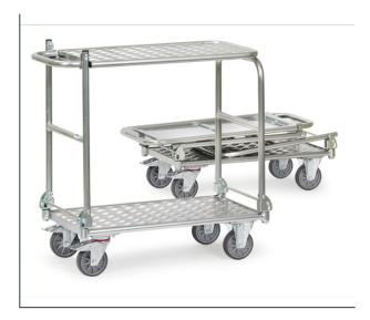
Alurohrwagen mit Aluplattform. Mit 2 klappbaren Bügeln und mit klappbarer Tischplattform. 2 Lenk- und 2 Bockrollen, TPE-Bereifung, Naben mit Rillenkugellager. Feststeller an den Lenkrollen, gemäß der Europäischen Norm EN 1757-3 (Sicherheit von Plattformwagen). Tragkraft obere Ladefläche 80 kg. Deutsches Patent 100 62 425.
