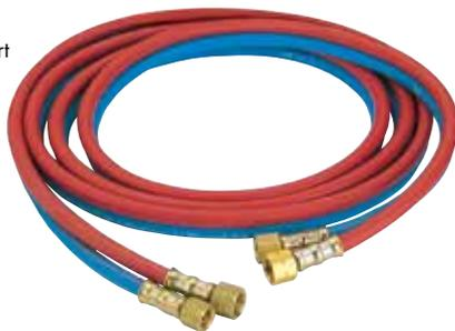
**Lieferumfang:** Acetylen Schlauch 9 x 3,5, Sauerstoffschlauch 6,0 x 5,0 – beidseitig mit Tülle und Überwurfmutter G 1/4" R bzw. G 3/8" L
