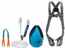
**Lieferumfang:** IKAR Auffanggurt IK G 1, Mitlaufendes Auffanggerät AG 01 einschließlich bewegliche Führung Verbindungsmittel, Kernmantelseil Ø 12 mm, Gesamtlänge 10 m; Anschlagschlinge 2 m, Gerätebeutel klein
