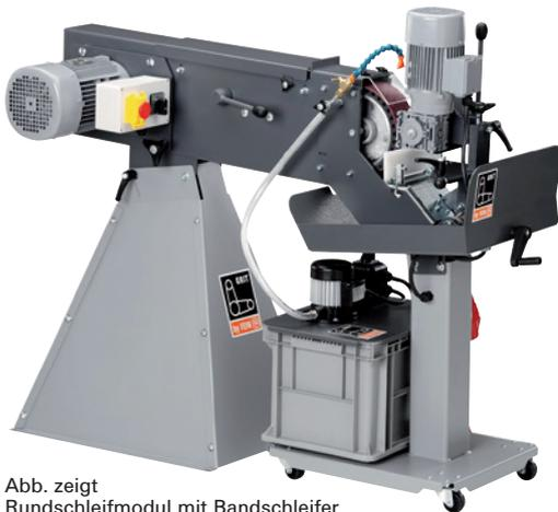
Abb. zeigt Rundschleifmodul mit Bandschleifer
